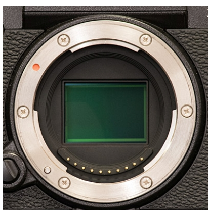
Capteur APS-C dans sa monture hybride
